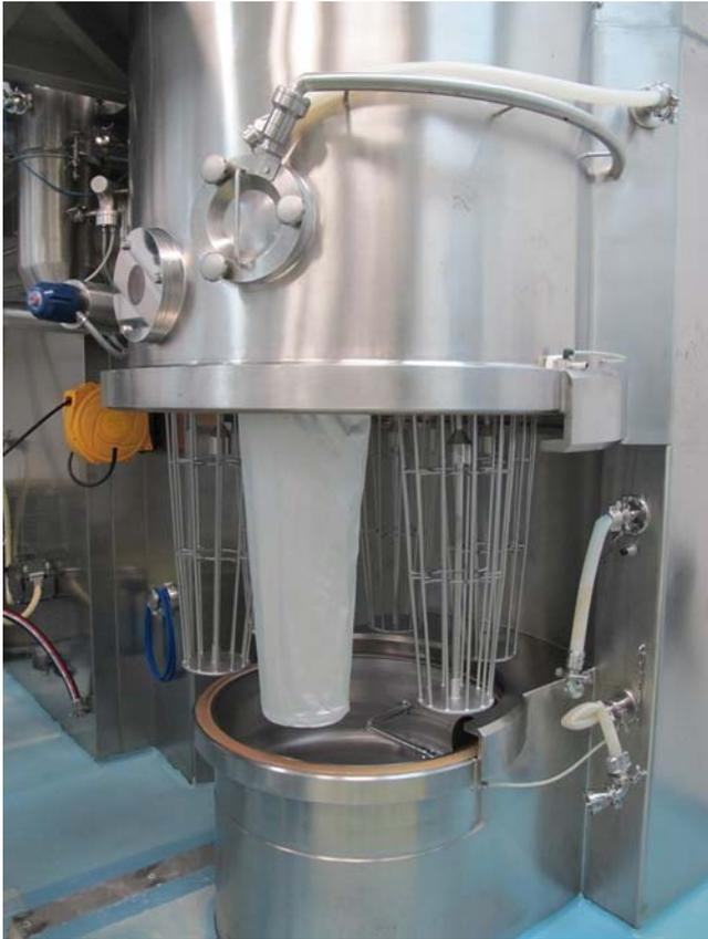
Proceso de montaje de las mangas en el equipo. Fabricación a medida.
