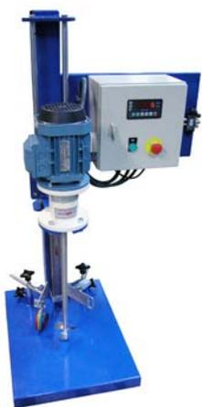
Los agitadores de laboratorio de Agitaser están especialmente diseñados para la fabricación y el testeo de cantidades pequeñas de producto, en recipientes de 50 litros de capacidad máxima.
