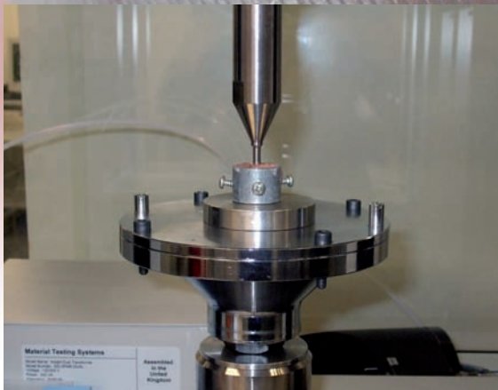
Figura 3. Montaje del ensayo mecánico de extracción por push-out (a) e imagen obtenida en el estudio histomorfométrico (b).
