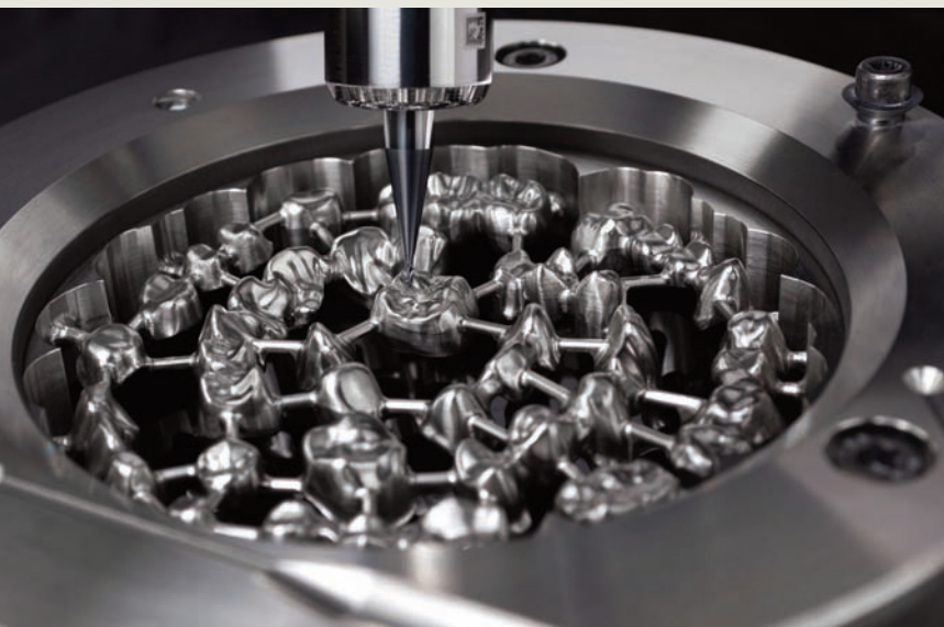
Coronas de cromo cobalto mecanizándose con Datron D5.
