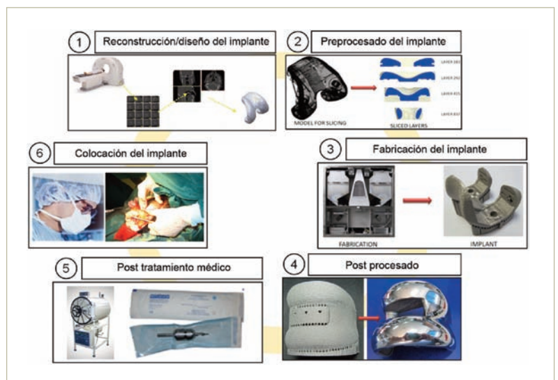
Figura 3. Flujo de trabajo en la fabricación de implantes personalizados usando tecnologías de FA.
