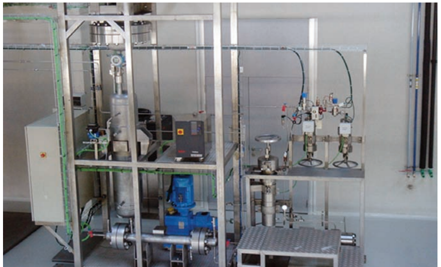
Planta completa de extracción de producto sólido
