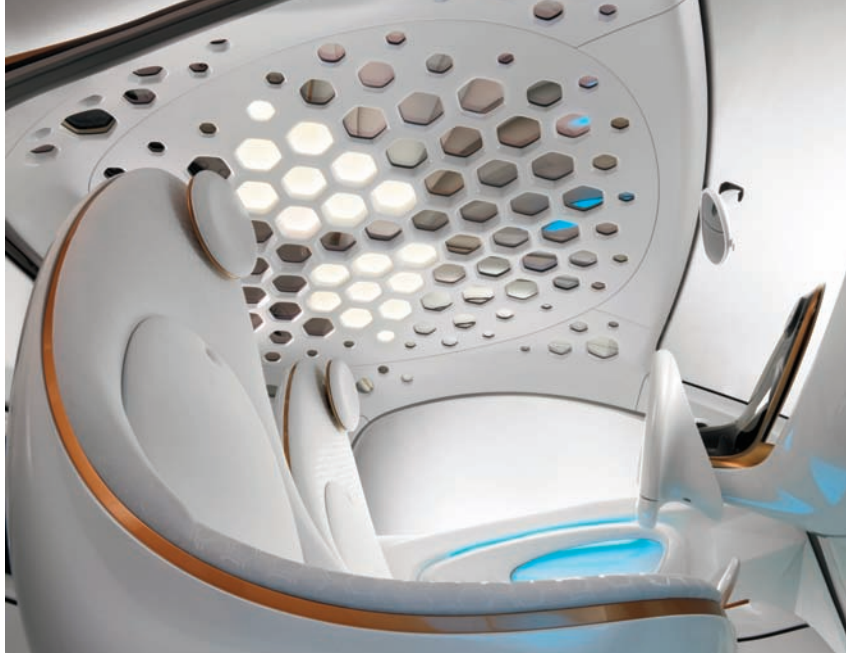
Techo del Smart Car de BASF y Daimler, el propio techo es una fuente de luz.
