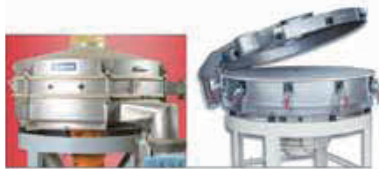
Tamizadoras vibrantes VTS/VRS para tamizado en vía seca o húmeda
