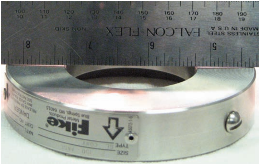
Figura 4: La imagen muestra una excesiva sobrepresión del cabezal. Lo ideal sería que no existieran huecos entre el cabezal y la regla.
