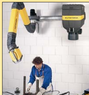
Aspiración de humos y su filtrado posterior.
