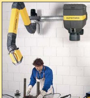
Aspiración de humos y su filtrado posterior.
