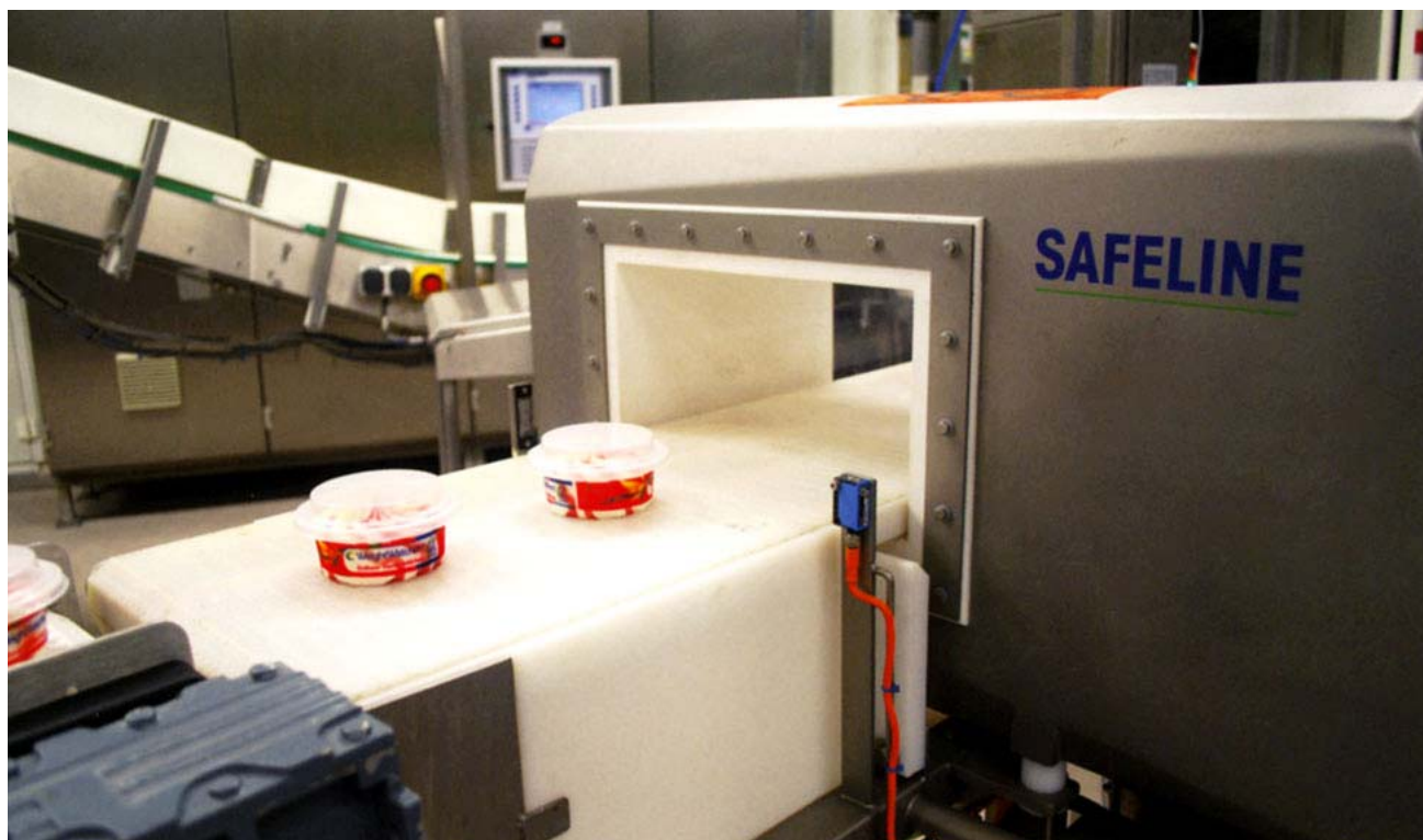
Equipo de Mettler Toledo para la detección de metales en helados de una fábrica alemana.
