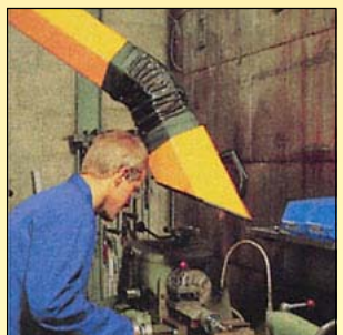
Aspiración localizada en mecanizado de piezas.
