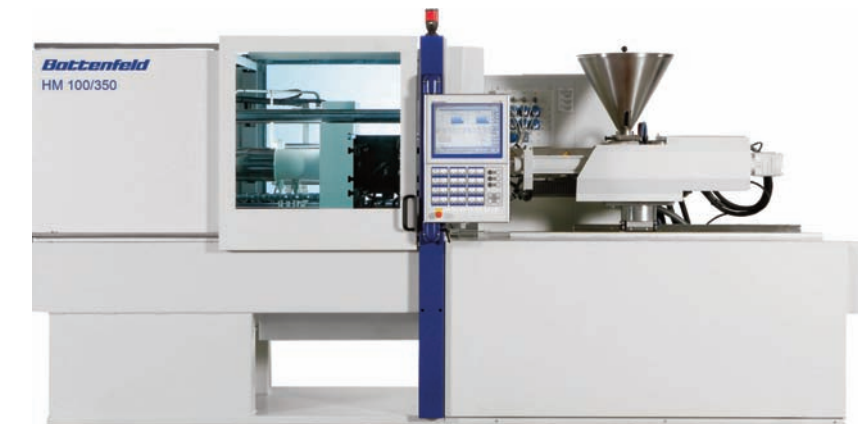
Máquina de inyección de plástico Wittmann Battenfeld HM 110/350 con sistema de control de UNILOG B6.
