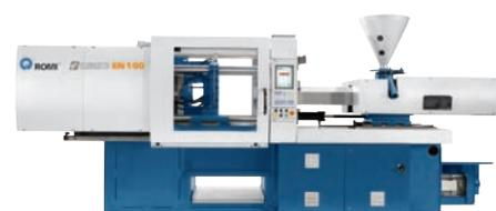
La serie Sandretto EN está diseñada con tecnología de última generación y equipada con bombas accionadas por inverter controlado por motor, para proporcionar ahorro de energía con un excelente rendimiento, ofreciendo ahorro de energía de hasta un 40% y una baja emisión de ruidos.
