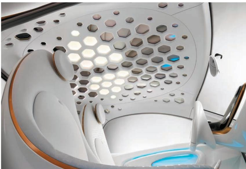
Techo del Smart Car de BASF y Daimler, el propio techo es una fuente de luz.
