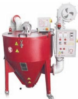
Equipo híbrido que puede funcionar como un mezclador estándar o bien como una tolva de secado. Puede hacer las dos funciones al mismo tiempo consiguiendo de esta manera un ahorro importante en la elaboración del material, ya que los procesos de mezcla y secado del material se realizan en un solo proceso. Además, el tiempo de secado del
