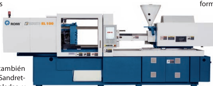
El modelo Sandretto EL 100, de 100 toneladas de cierre, ofrece un ahorro energético de hasta un 60%.
