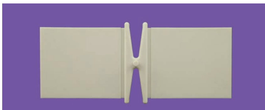
Fig. 1. La pieza moldeada por inyección es una simple placa (molde de dos cavidades). El volumen total de inyección es de unos 64 cm 3 .
