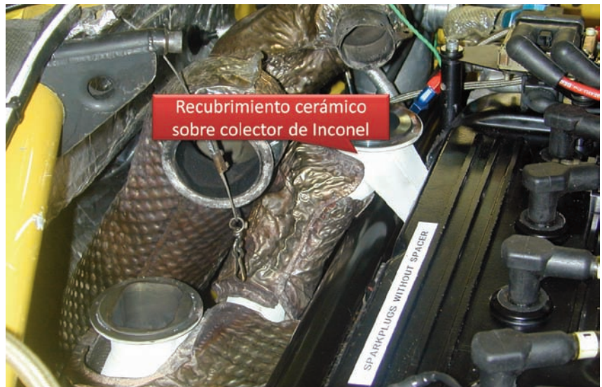
Ejemplo de aplicación. Recubrimiento cerámico aplicado sobre el colector de un motor de explosión en un coche de competición, para mejorar el rendimiento energético.
