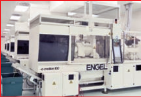
Inyectoras eléctricas en sala blanca
