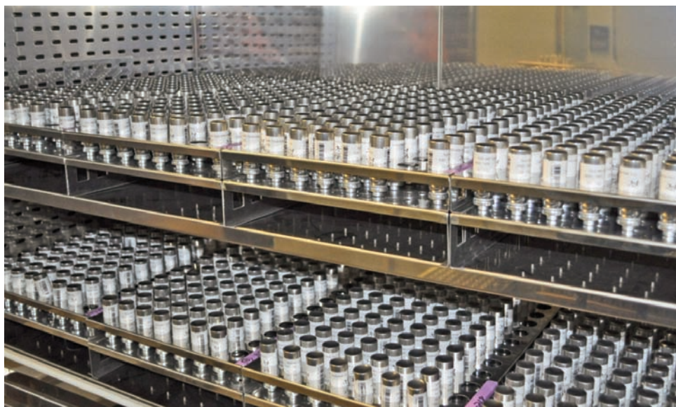
V.A.R.I. produce componentes termoplásticos para válvulas de aerosoles en inyectoras eléctricas e-motion de Engel. La sala blanca tiene la certificación ISO 8, mientras el sistema de flujo laminar garantiza condiciones de sala blanca ISO 7 en las unidades de cierre. (Foto: Engel)
