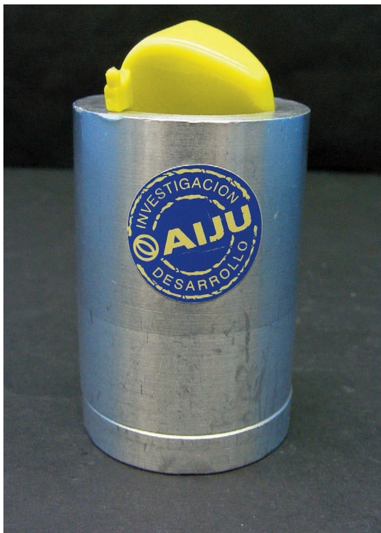
Cilindro para partes pequeñas. Ningún componente del artículo debe caber completamente en el cilindro, sea cual sea la orientación y sin compresión.
