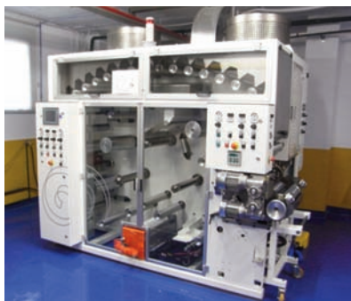
Figura 5. Laminadora semi-industrial instalaciones Aimplas.
