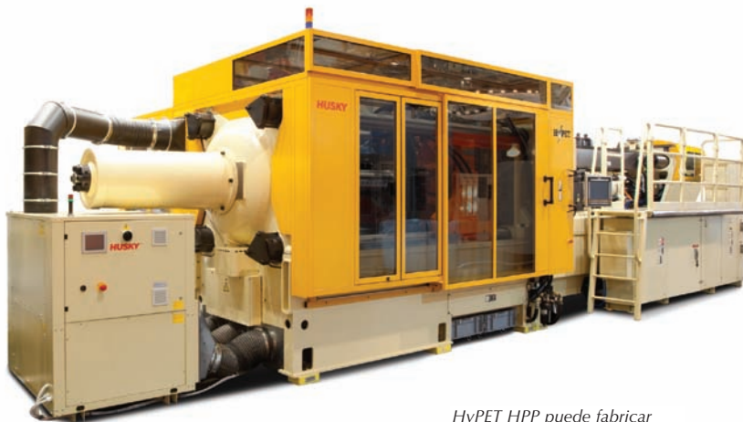
HyPET HPP puede fabricar una preforma con un espesor de pared de 1,5 mm y una pared de la rosca de 0,8 mm, para una botella de 500 ml para agua sin gas.
