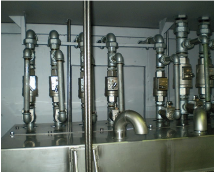
Las cabinas dosificadoras de plastificantes de Solids System-Technik disponen de entradas para 8 tipos diferentes de plastificantes.
