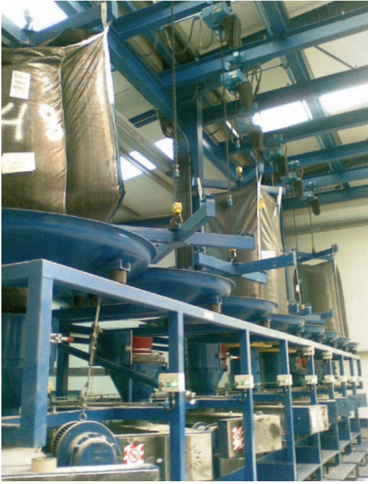
Solids System-Technik ha desarrollado instalaciones para el manejo automático de este producto en diversas empresas del sector de las mezclas de caucho.
