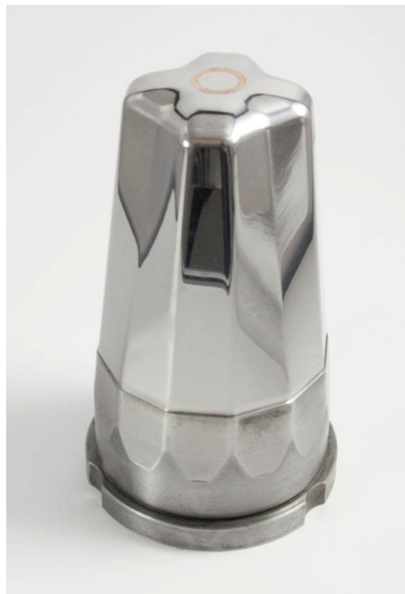
Inserto para la fabricación de un vaso de plástico para niños, material EOS Maraging SteelMS1 (1.2709). La producción de la parte inferior es convencional. Fuente: BKL, Polymold, EOS.
