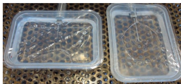
Figura 1. Barquetas llenas de silicona, con las sondas colocadas.
