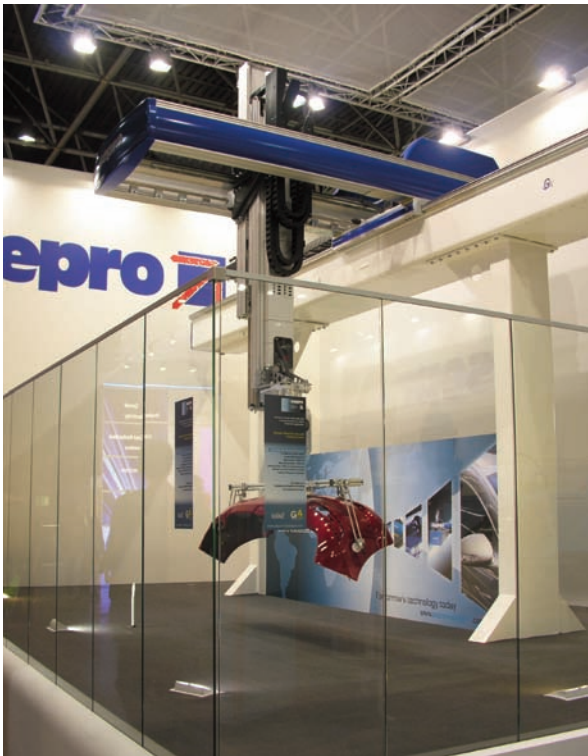
Sepro expuso, entre otros, este robot con integración de una rotación equipada con 3 ejes servo en la muñeca del robot.
