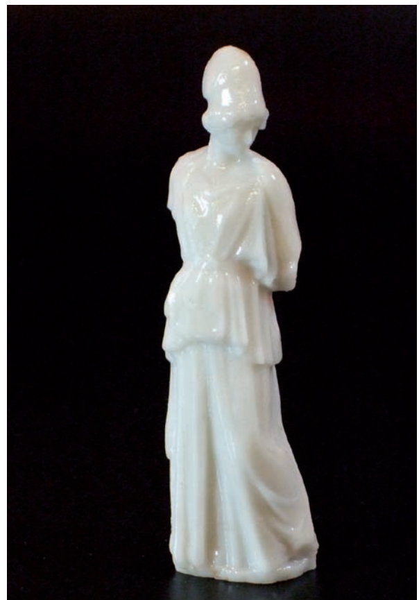
Modelo máster en miniatura hecho con Somos NanoTool.
