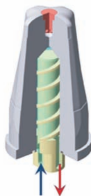
Foto 1. Simulación de la refrigeración del inserto para copa de niño. Foto cortesía de BKL.
