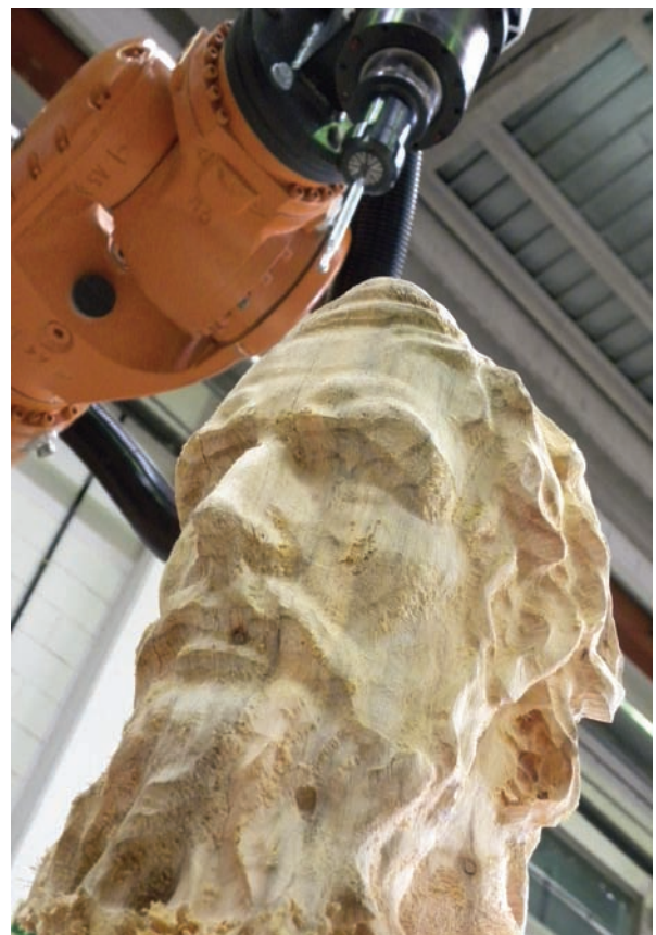
Los robots de la serie Quantec ofrecen “una gran repetibilidad de precisión y postura de \pm 0,06 milímetros”.
