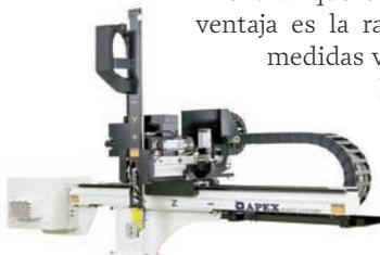
Robot de tres ejes con servomotor CNC.
