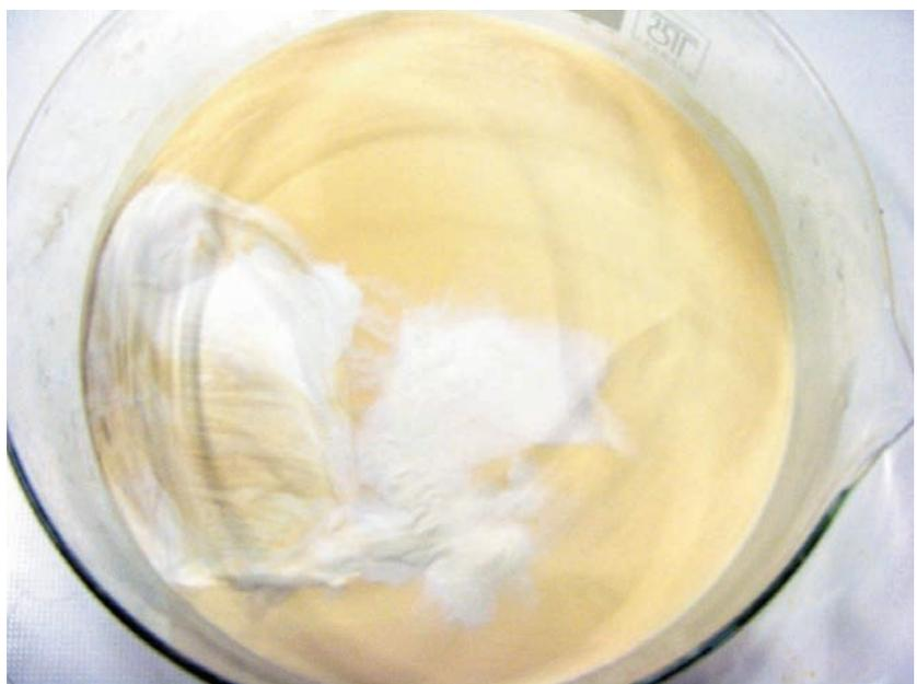
Figura 1. Aspecto que presentaba la muestra tras 3 horas de acondicionamiento a 130 °C.
