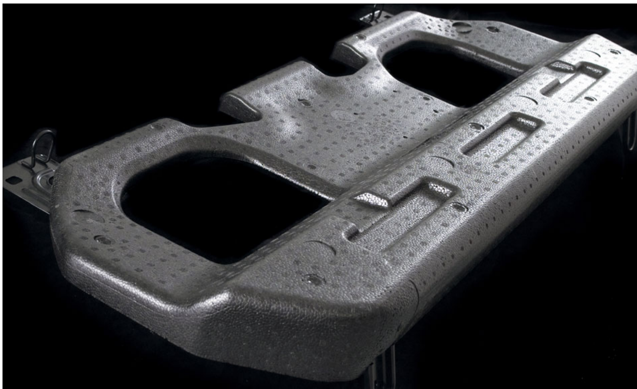
El uso de Arpro en el nuevo C3 permitió a los ingenieros sustituir una estructura de acero pesada y costosa por un material resistente, ligero y reciclable.
