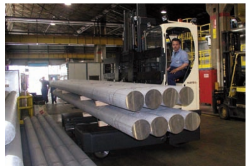
Carretilla de carga lateral multidireccional Hubtex.
