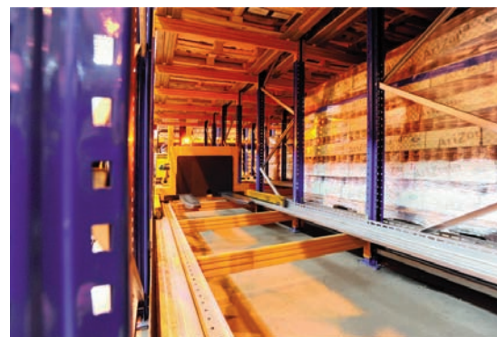
In Pallet Carrier (IPC), en el que se maneja el 'shuttle' y el palé simultáneamente.
