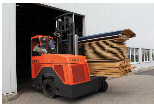
Triciclo 'cuatrocaminos' de carga lateral serie 3050 con tracción en las tres ruedas.
