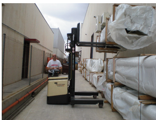
Apilador de corriente alterna de Hubtex.
