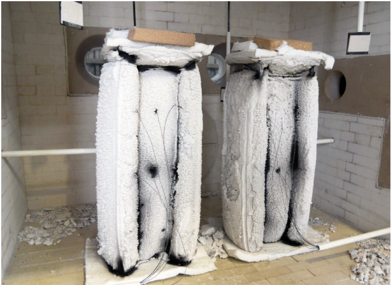
Los recubrimientos intumescentes permiten disponer de más tiempo de evacuación y reacción en la actuación de los servicios de emergencia.
