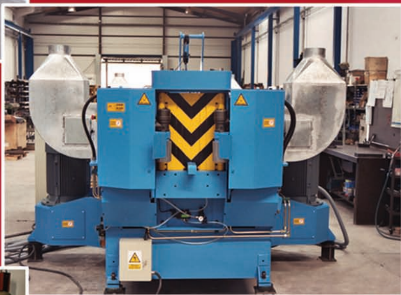
B24 N - Máq. Sierras Múltiple para tablas, avances por rodillos
