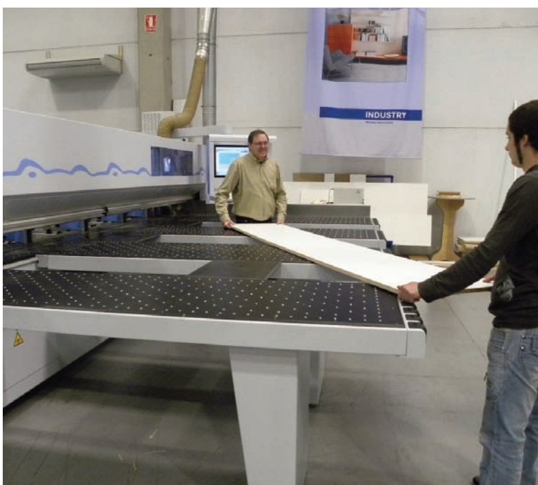
Una demostración del trabajo de la nueva seccionadora.
