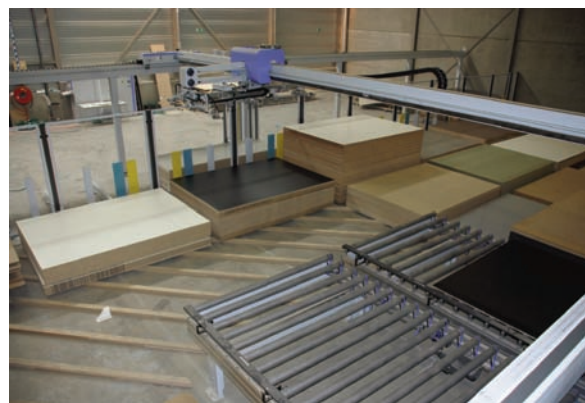
Los paneles destinados a la mecanización son transportados a través de un tránsfer angular bajo los pórticos del cargador.
