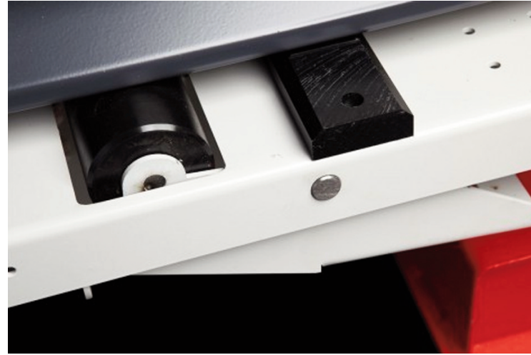
La sierra cuenta con unos rodillos de transporte de activación neumática.
