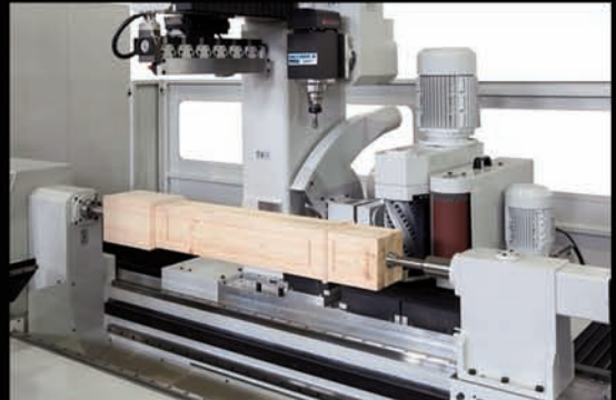
mecanización de columnas hasta cuadrado max. 200x200x3000
