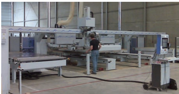
Las piezas cortadas se despidan manualmente.
