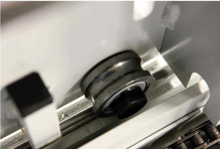
La guía superior de la columna es de acero endurecido.
