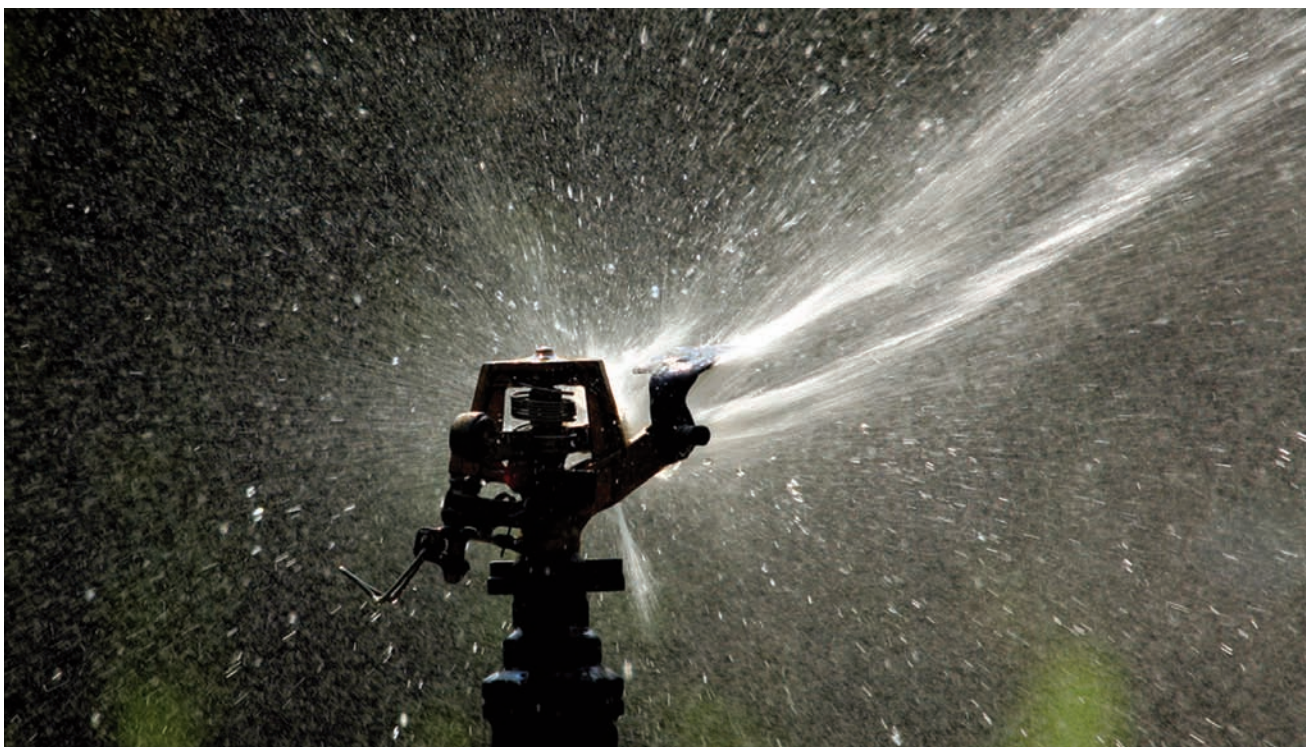
En el diseño de los sistemas, el aspersor se suele colocar lo más bajo posible, según la altura de las plantas a regar.
