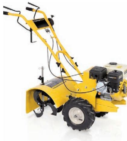
El cultivador modelo POW XG7205, de Varo Ibérica Bricolaje, incorpora un depósito de 3,6 l de gasolina y 0,6 l de aceite y trabaja con una potencia de 6,5 HP a 3.600 rpm. Con una cilindrada de 196 cm<sup>3</sup>. El objetivo de labranza es de 500 mm, con una profundidad de 175 a 350 mm.
