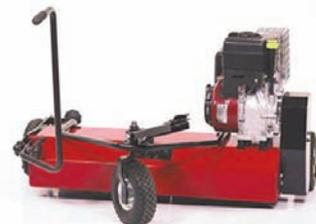
Escarificadora de arrastre con motor autónomo. La anchura útil es de 90 cm y el rotor incorpora 60 cuchillas flotantes. La altura de corte se puede regular desde 0 hasta 30 mm. Puede montar motor Honda GX 240 de 8 CV o Briggs & Stratton de 8,5 CV.
