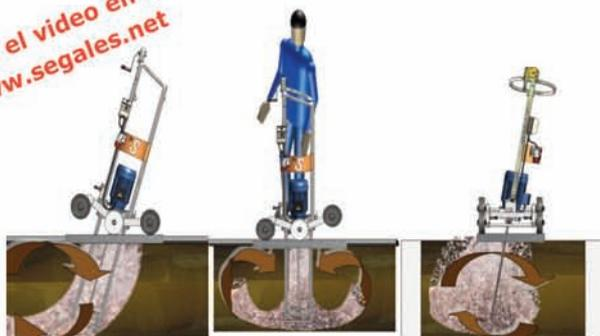
**Multidireccional** el sistema **slinger**, nos permite agitar en cinco posiciones fijas diferentes o moverlo libremente tanto en sentido horizontal como lateral de la fosa.
