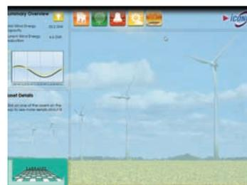
Basa su funcionamiento en HyperHistorian que, gracias a su capacidad para tratar gran cantidad de datos a enorme velocidad, provee un eficiente método FDD (Fault Detection and Diagnostics), identificando además factores que reduzcan el rendimiento general de la instalación.
