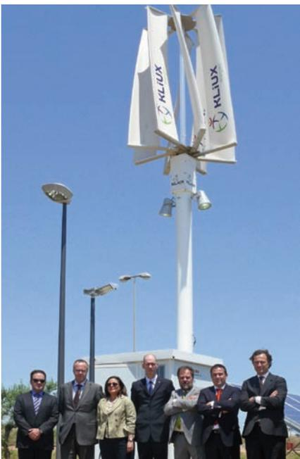
Los aerogeneradores de Kliux se caracterizan por estar siempre orientados al viento, giran incluso con poca fuerza eólica.
