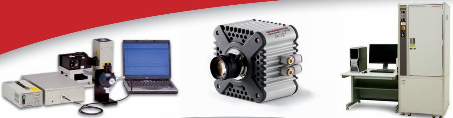
El sistema de análisis por imagen EL / PL es la última herramienta para la caracterización y mejora en el proceso de células solares según los métodos de Electroluminiscencia y Fotoluminiscencia. Caracteriza diferentes tipos de células solares, módulos y otras tecnologías novedosas basadas en Thin Films y Silicio cristalino.
