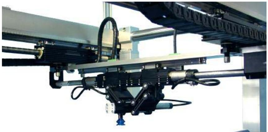
del estator, por lo que el sistema goza de una dinámica muy alta. Las velocidades superan los 6 m/sg y las aceleraciones pasan de 300 m/sg<sup>2</sup>, sin dar lugar a ningún tipo de desgaste mecánico. Finalmente, la sencillez de montaje hace posible la sujeción por el vástago o los devanados.
