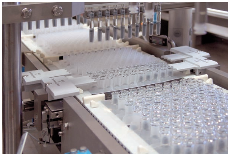
Track and Trace: las jeringuillas se introducen en los llamados nidos y después se embalan en tubos. En estas cajas de plástico pueden imprimirse códigos en Optima Group Pharma. Foto: Optima Packaging Group.
