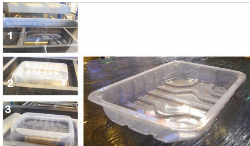
Figura 2. Proceso de termoconformado.
