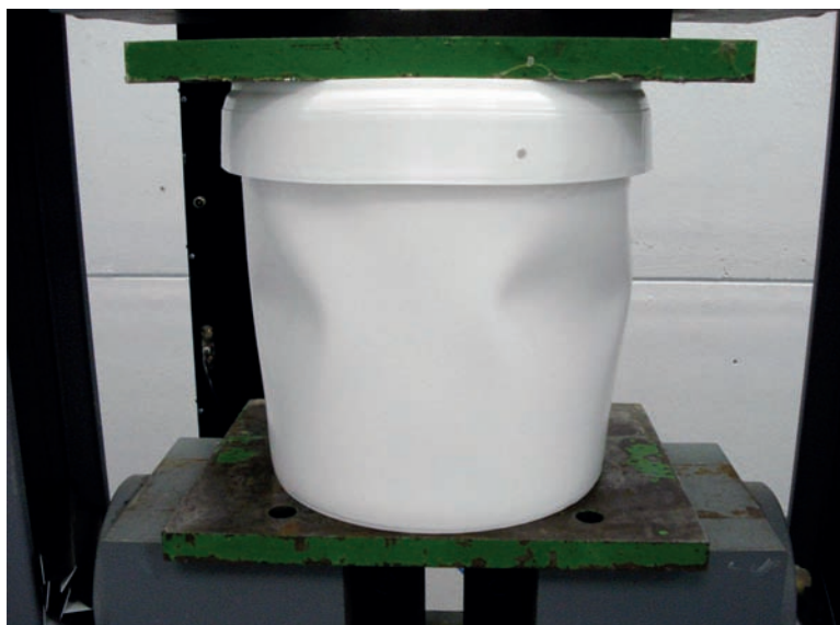
Fotografía de detalle del ensayo de compresión.
