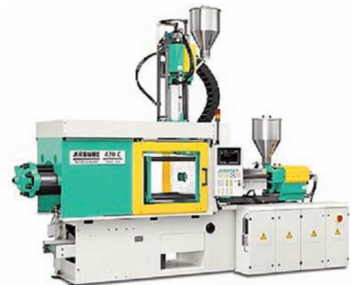
Figura 2. Para poder realizar la coinyección se necesita una máquina de inyección bi-materia.
