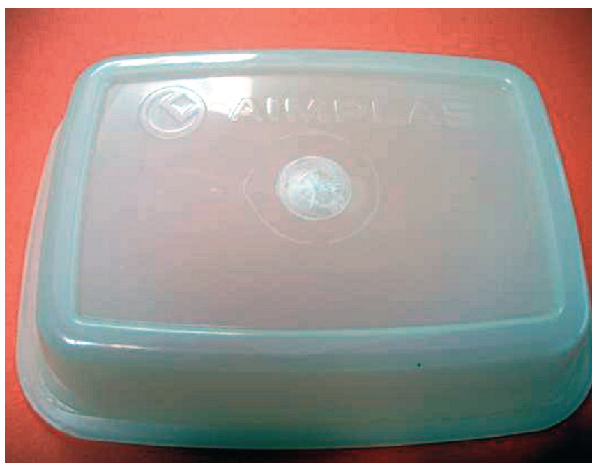
Figura 4. Envase desarrollado mediante coinyección.
