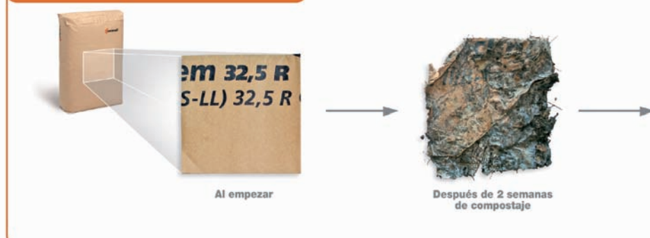
Test de desintegración realizado por Organic Waste Systems
