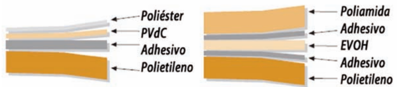
Figura 1: Ejemplos de estructuras multicapas de film plásticos destinados a la fabricación de envases para alimentos en atmósfera modificada (Fuente: Informe de vigilancia tecnológica de Tecnologías de Envasado en Atmósferas Protectoras, Aseacam).
