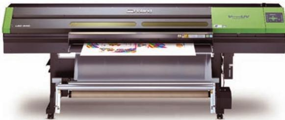
Roland VersaUV LEC 540 es un plotter de inyección y corte de tintas CMYK, blanco y barniz. Capaz de lograr la opacidad de la serigrafía, este equipo puede imprimir sobre gran variedad de materiales (etiquetas, cajas, paneles de control, piel artificial, flexografía, papel retráctil, impresión de braille...). El plotter está dirigido a múltiples mercados: packaging, interiorismo, personalización de objetos, cosmética, alimentación...
