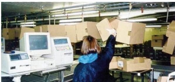
El sistema de transporte aéreo monorraíl con motorización y sistemas de acumulación de Rodant, se realiza según requerimiento del proyecto. El peso es de hasta 30 kg por soporte. Las velocidades se pueden regular hasta 100 m/min mecánicamente.
