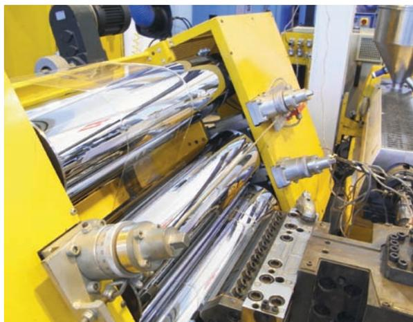
*Proceso de coextrusión de lámina.*
