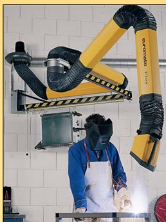
Brazo articulado de aspiración unido a prolongación para alcance de hasta 8 m.
