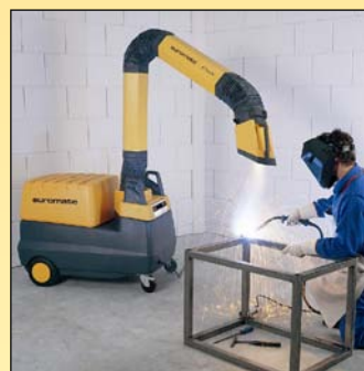
Equipo móvil de extracción provisto de brazo articulado y filtro.
