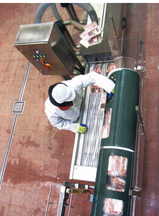
Fig.1. Procesador de envases de carne, tratada por altas presiones. Gentileza de Hyperbaric, Burgos.
