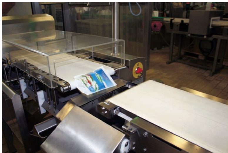
El producto se rechaza por medio de un sistema 'trampilla'.
