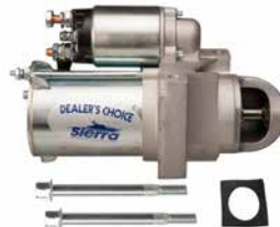
18-6275 MOTOR ARRANQUE Reemplaza: 3857747, 3860566 • Intraborda • Reducción magnética permanente • 2 tornillos largos • Rotación sentido agujas del reloj • Usar con último Modelo 3.0L motores con 14" volante Reemplaza solenoide: 18-5811 Para : Volvo Penta, Mercruiser, Marine Power
