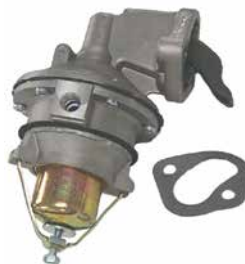
18-7278 BOMBA COMB Identificación D.I. # M60032 Reemplaza: 86234A4, 86234A05, 86234A3, 86234, 77594, 71327, 47585 Para: GM (4 & 6 Cil.) 153, 181, 225, 250, 120 / 140 / 160 / 165 / 470 / 485 / 488 Use filtro 18-7860 & junta 18-0889
