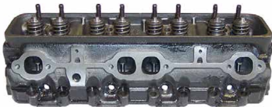
18-4485 CULATA Reemplaza: MerCruiser 938-883490R1, 938-883490, 938-883490R50, 938-884741R, 938-884741 R50 Para: 5.7L V-8 GM (1987-95) con 12 pernos en el colector de admisión. Tornillos de fijación (4 dentro de los pernos del colector de admisión a 23 grados), tapas de válvula de montaje central
