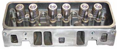
18-4491 CULATA Reemplaza: MerCruiser 938-827178 Reemplaza 4.3L Vortec V-6 (1996-sup) con tornillo en los esparragos del brazo (válvula no ajustable), colector de admisión con 8 tornillos, tapa válvula centrada. NOTA: No utilizar con motores con balancines de fábrica.
