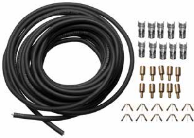
18-5225 KIT CABLE BUJÍAS El kit incluye 7,5 mts de cable de encendido de hypalon de 7mm y un surtido de 3 terminales diferentes para fueraborda..
