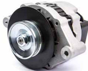
18-6261 ALTERNADOR Reemplaza: 3856600-6, 3857561 Mando para último Modelo Volvo Penta, 12 Volt, 65 Amp, Regulador interno, Single Polea estrias
