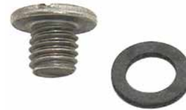
18-72656 TAPÓN DE DRENAJE Y JUNTA Reemplaza: Nissan-Tohatsu 332600051M, 332600060M M8 - 1.25 dientes Para: Nissan/Tohatsu - Todos los modelos
