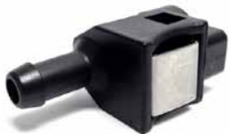
18-80403 CONECTOR COMBUSTIBLE Conector de manguera de 3/8 hembra con bloqueo rectangular post, no se intercambiarán con OE's 5/16" conjuntos de manguera. Para los modelos de motor: Para uso con nuestro 18-81042 conjunto de manguera de combustible, lado motor. Se acopla con 18-80407
