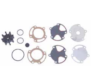
18-3318 KIT BOMBA AGUA Reemplaza: 47-59362Q08 Para: 1 plástico y 2 piezas cuerpos bomba
