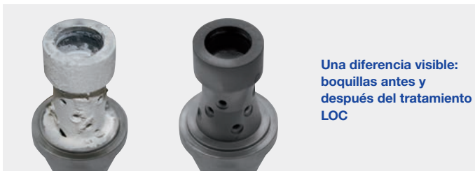
Limpienza cíclica con ácido cítrico dopado en aire comprimido
