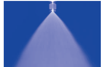
Patrón de rociado de una sola boquilla de retorno (spillback)
