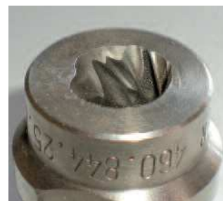
Ilustración 19. Desgaste de una tobera de cono lleno
