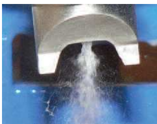
Ilustración 16. Pulverización de gelatina con la tobera de fluido doble Lechler ViscoMist
