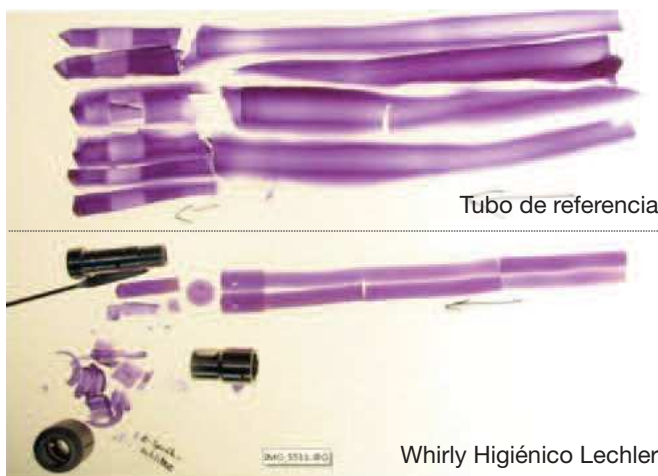
Ilustración 11. Test EHEDG in situ de facilidad de limpieza de un Whirly Higiénico Lechler. El resultado no muestra diferencias entre el tubo de referencia y el Whirly Higiénico. En ambos casos, el color del cultivo es morado, lo que indica que no se han formado gérmenes.
