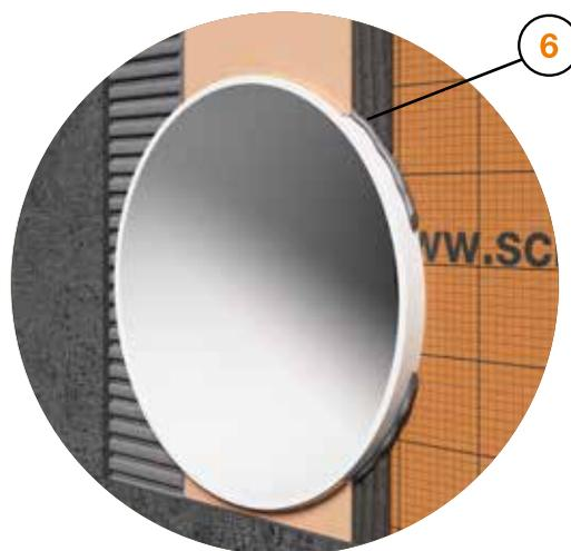
Detalle del pegado del babero **Schlüter®-KERDI** con el polímero elástico **Schlüter®-KERDI-FIX** a los elementos de plástico y metálicos de skimmers, focos y sumideros. El área de aplicación debe de estar limpia, ser estable y resistente. La superficie a pegar debe ser apta para el adhesivo, ser firme y libre de componentes sueltos.
