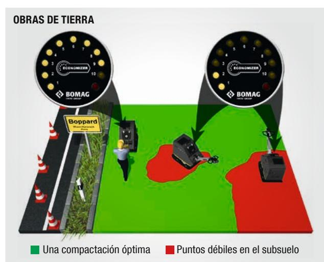
Unos diodos luminosos le muestran al conductor el grado de compactación.
