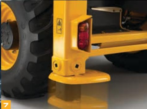
**6 Bloqueo automático de la pluma (solo servo).**
