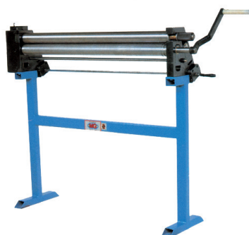
CILINDRO PARA CURVAR PLANCHA DE 1000 X 1,25 MM
