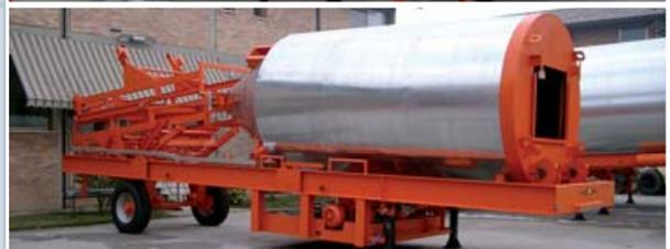
ROADSTAR, secador, torre de mezcla y cabina
