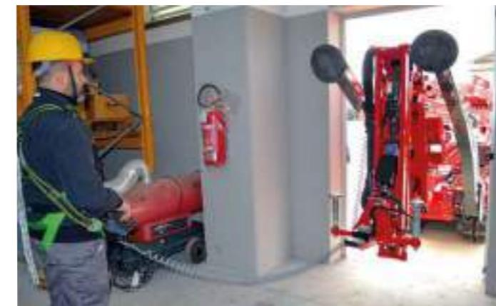
**Sottocarro** che permette una maggior stabilità, un migliore angolo di attacco e la riduzione della pressione al suolo in fase di traslazione.
