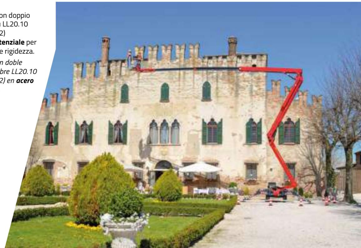
Altezza della macchina in fase di traslazione inferiore a 2 m, per permettere un agevole passaggio da una porta.
