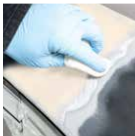
Aplicación de BONDERITE M-NT 1455 W solo sobre la superficie de metal sin tratar. Mantener húmedo durante 2 min
