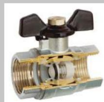
Válvula de esfera con retención incorporada, combina en un solo cuerpo 2 funciones (válvula de corte + válvula antiretorno); la doble función permite reducir el tiempo de montaje e instalar un dispositivo más compacto.
