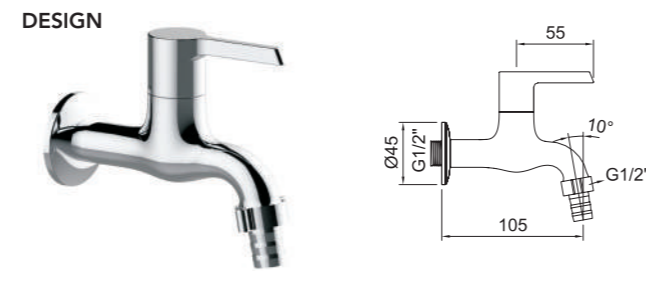
Grifo mural 1/2" con accesorio manguera. Wall mounted tap 1/2" with hose fitting. Robinet murale 1/2" avec raccord pour tuyau.
