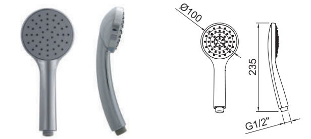
Teléfono ducha City Air Ø100mm. City Air shower handset Ø100mm. Douchette City Air Ø100mm.
