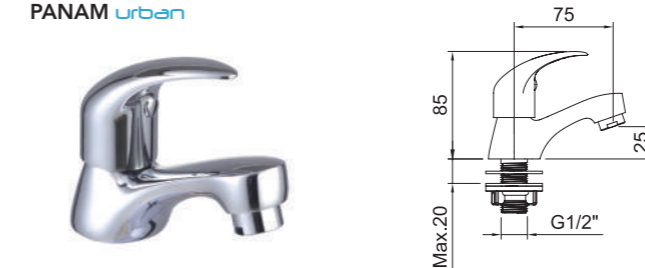
Grifo lavabo repisa 1/2" con aireador. Deck mounted basin tap 1/2" with aerator. Robinet lavabo sur plage 1/2" avec aérateur.
