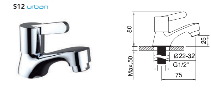
Grifo lavabo repisa 1/2" con aireador. Deck mounted basin tap 1/2" with aerator. Robinet lavabo sur plage 1/2" avec aérateur.
