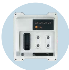
Controlador para aplicaciones móviles Controlador de seguridad con CANopen Safety
