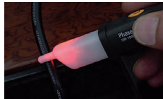
Encendido LED rojo con tensión detectada
