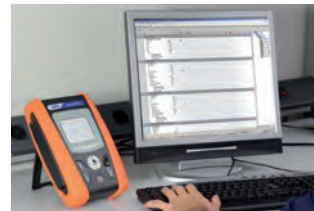
Transferencia de datos a PC a través de conexión óptico/USB u óptico/Wi-Fi
