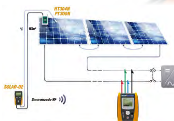
Medida de una curva I-V con sincronización a distancia de irradiación y temperatura
