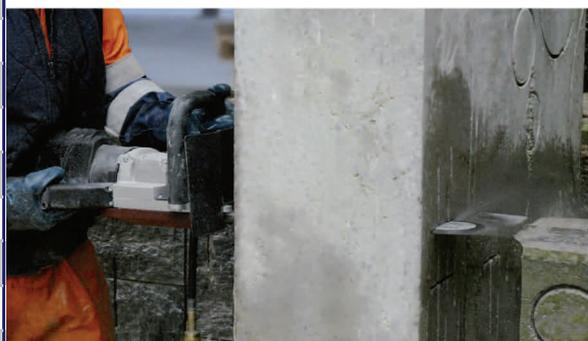
**COCCODRILLO35** es la primera sierra con motor eléctrico de una sola fase que permite cortar en húmedo en hormigón, piedra, ladrillos y materiales de construcción en general.
