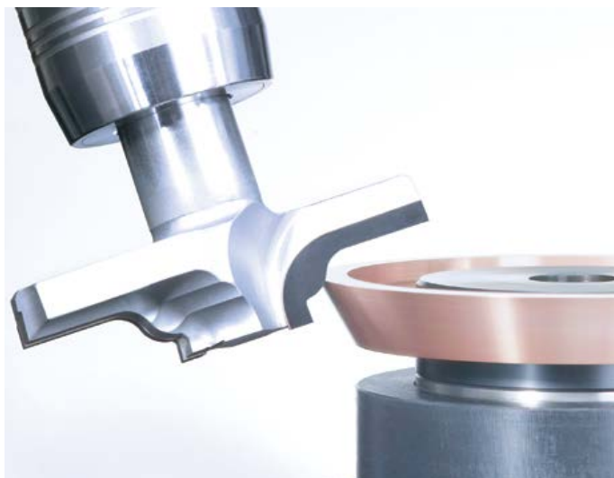
/// EROSIÓN DE UNA PIEZA DE TRABAJO DE PERFILADO
