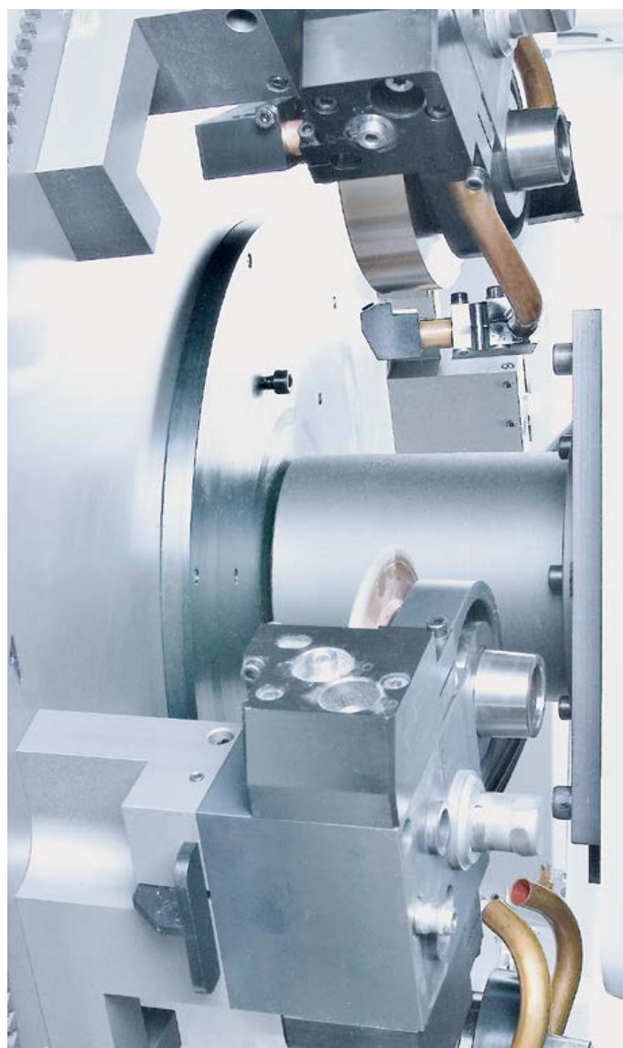
/// ALMACÉN DE 6 HERRAMIENTAS para herramientas hasta 200 mm de diámetro
