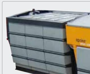
Su especial diseño modular asegura una distribución de líquido estable en los tanques. Duraderos depósitos de líquido contruidos en material termoplástico resistentes en condiciones climáticas extremas.
