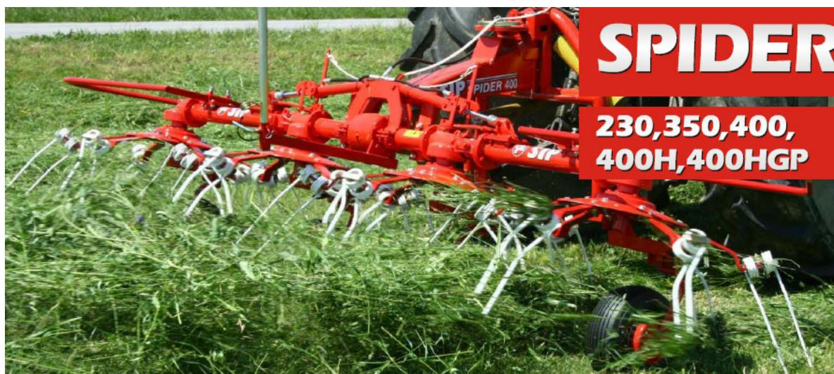
•El SPIDER 230 es un volteador con cabezal fijo, maniobrable debido a su diseño y facil de mantener. Con bajo mantenimiento y buena maniobrabilidad es ideal para pequeños ganaderos
